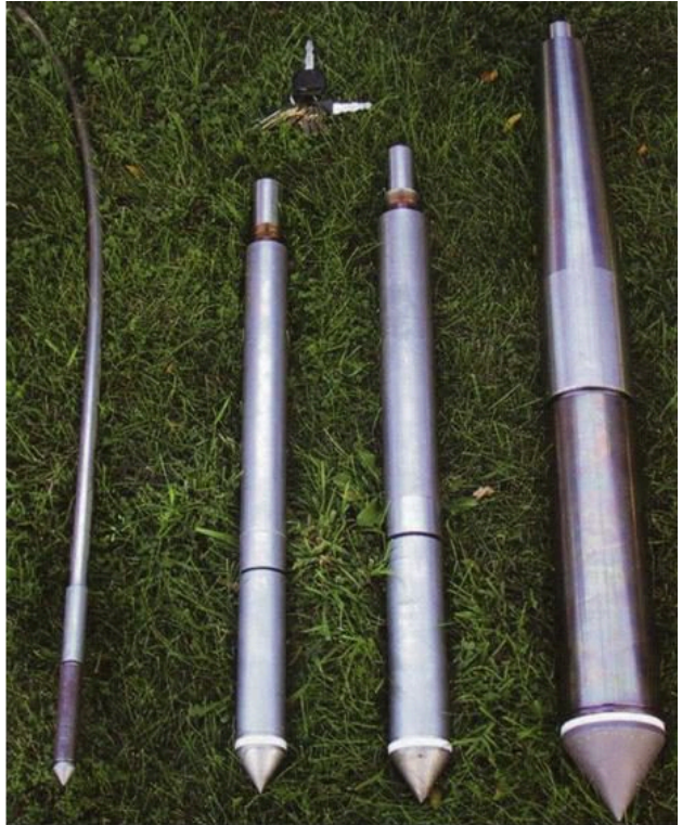
Figura 44. Equipos de piezocono y conos eléctricos usados en la exploración de lumbreras
