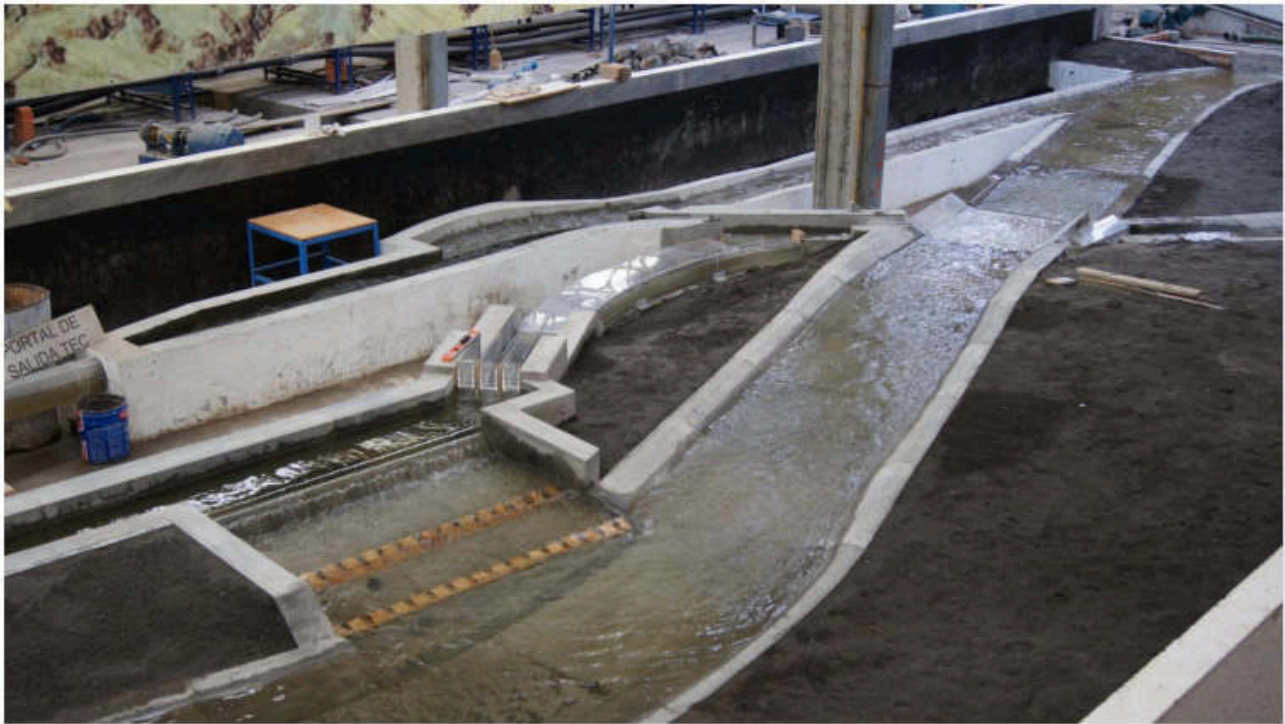
Figura 17.1. Modelo físico para el manejo de caudales a la salida del TEO
