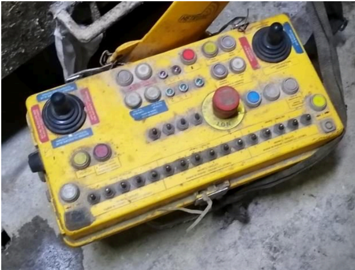
Figura 20.9. Panel de radiocontrol de la grúa de dovelas
