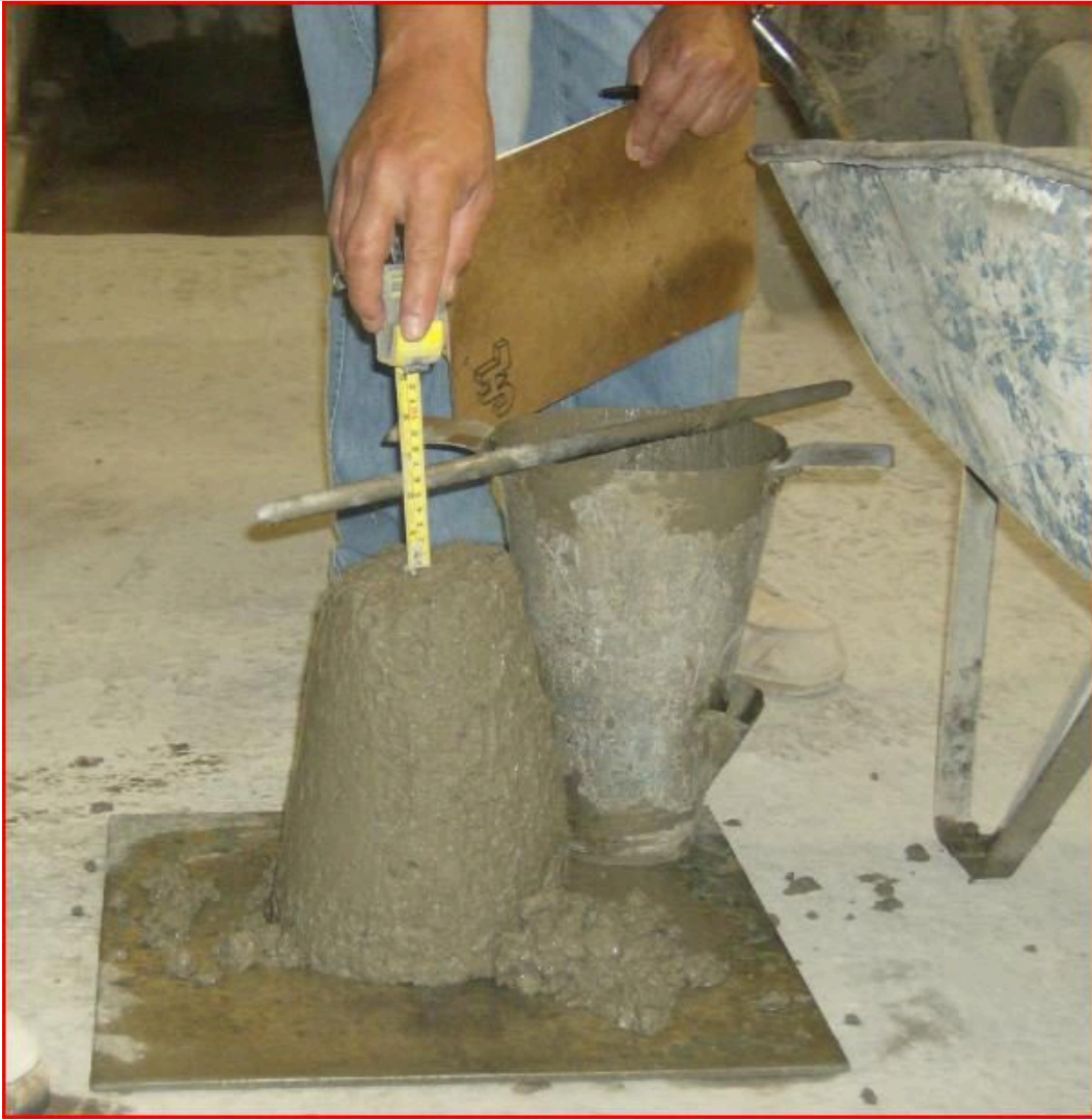
Figura 16.14. Prueba de revenimiento del concreto fresco con cono y cinta métrica
