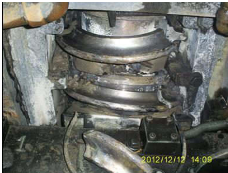
Figura 14.86. Daño en un cortador central de la rueda
