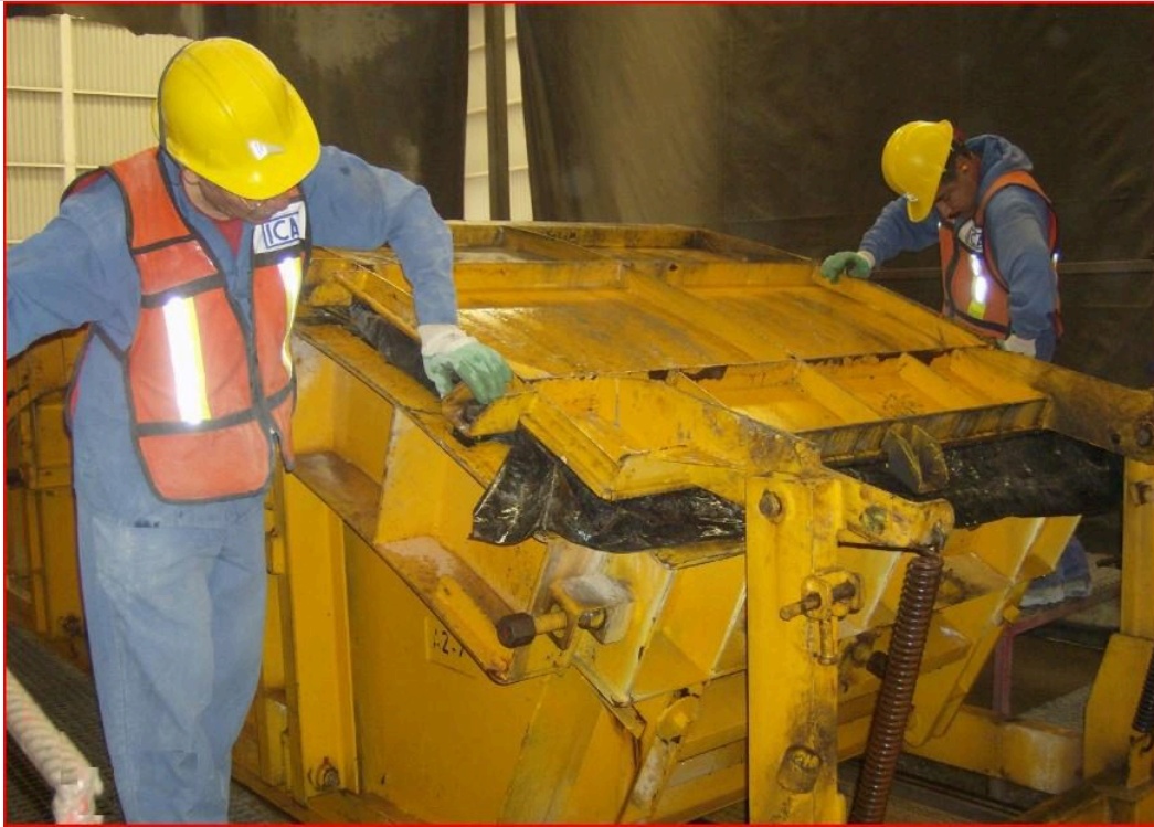
Figura 16.5. Molde metálico de dovela en la línea de producción
