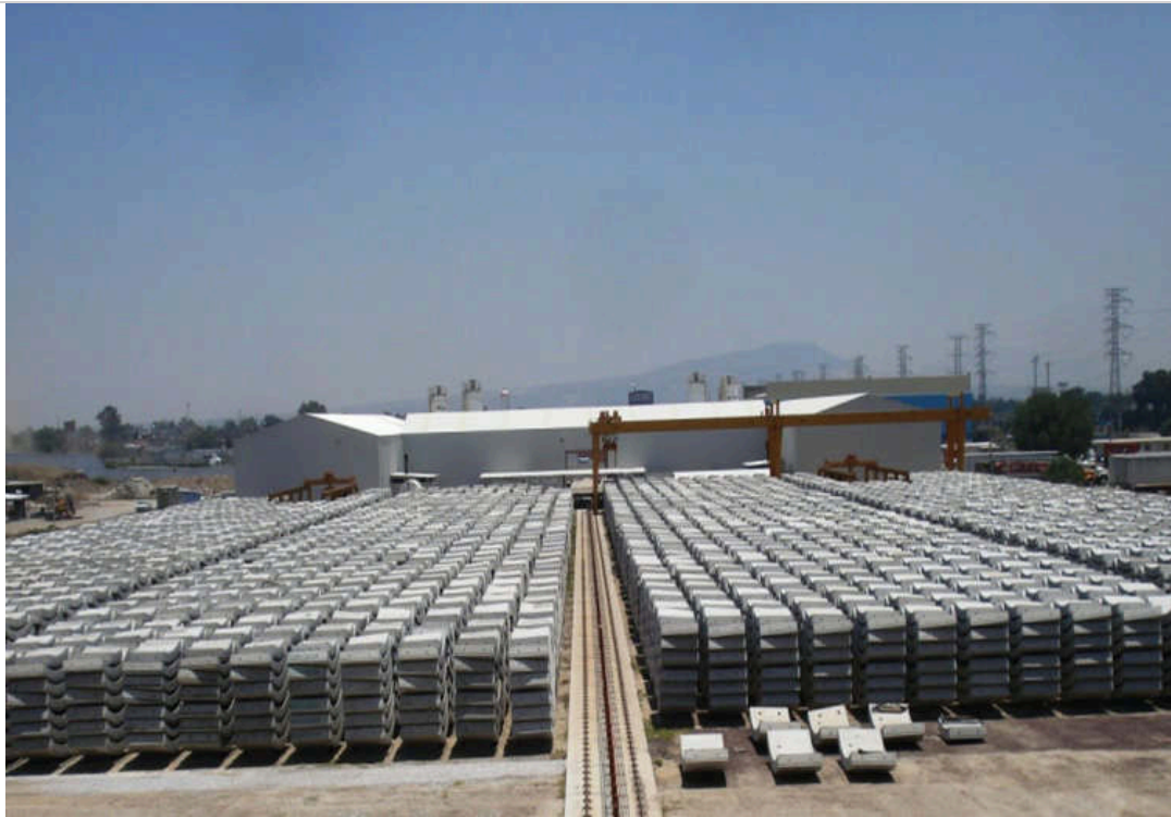
Figura 16.11. Patio de almacenamiento de dovelas en la planta de Ecatepec
