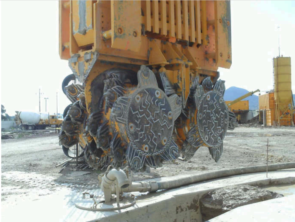
Figura 14.23. Detalle del cortador de la hidrofresa
