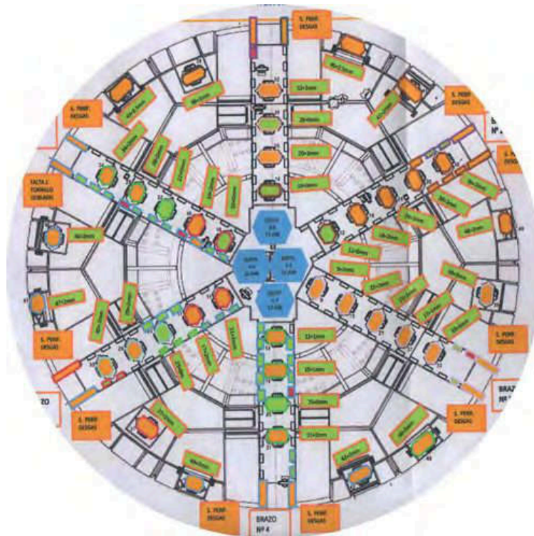
Figura 14.19. Rueda de corte de la tuneladora con la posición y el tamaño de los cortadores
