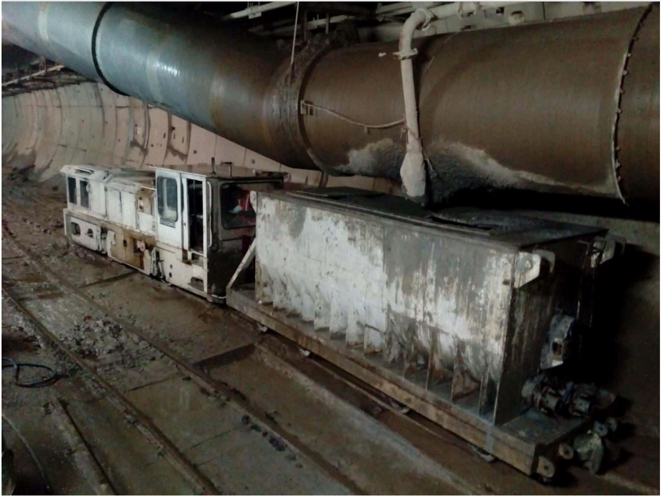
Figura 14.56. Transportador helicoidal ("vaca") de mortero de 8.5 m 3
