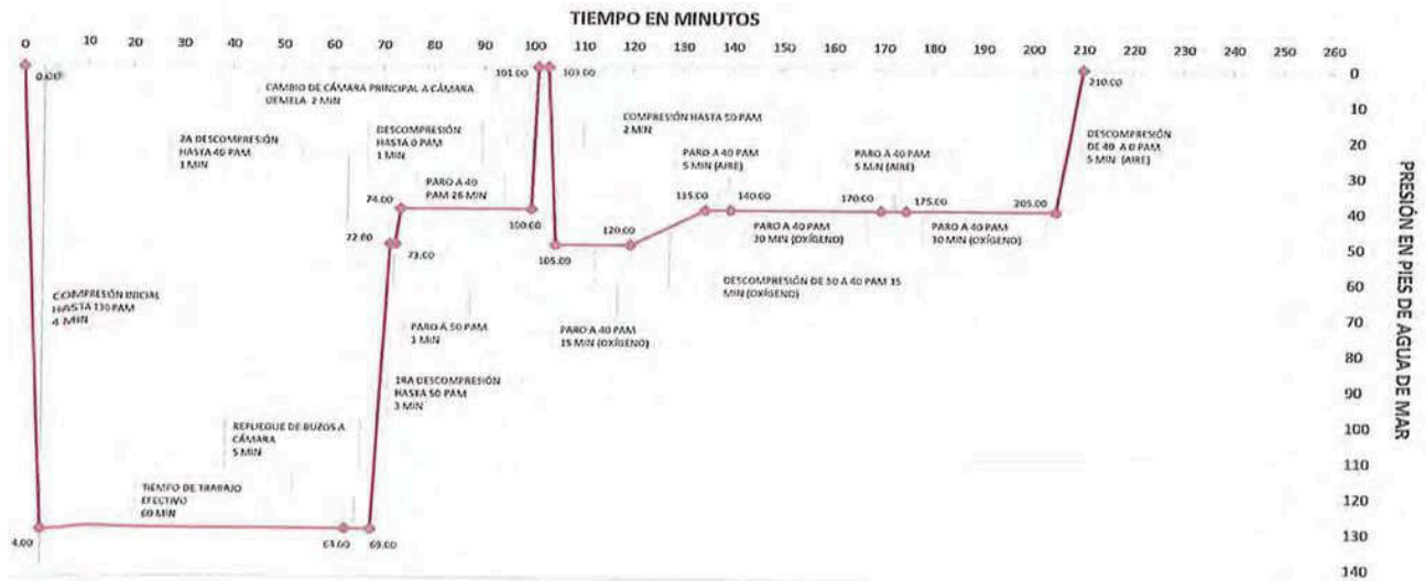
Figura 14.18. Perfil de compresión y descompresión de la tercera prueba, de 69 minutos de trabajo
