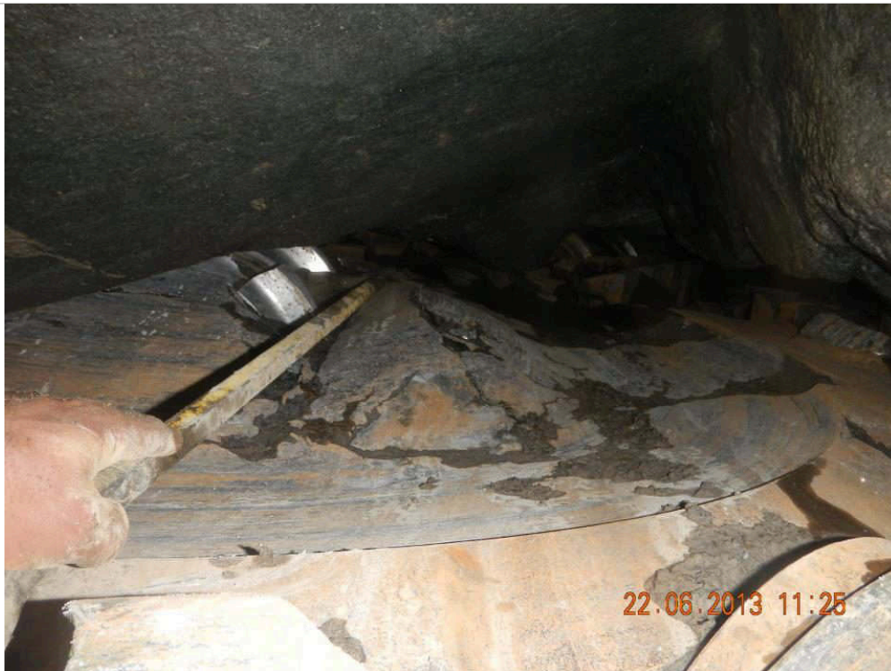
Figura 14.87. Desgaste de hasta 50 mm en el cuerpo de la rueda
