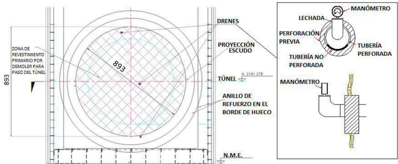
Figura 14.78. Colocación de drenes de medición en el portal de lumbrera
