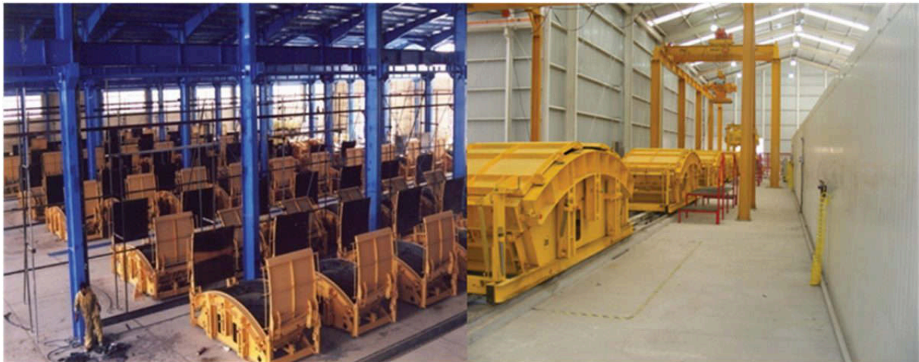
Figura 16.8. Planta estacionaria y planta tipo carrusel
