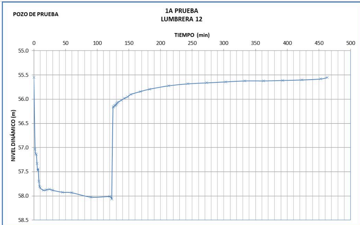
Figura 12.36. Prueba de bombeo en el pozo PB-3 de la L-12
