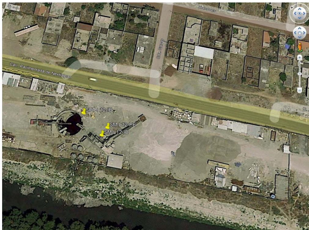
Figura 12.11. Sondeos de ingeniería básica y proyecto ejecutivo en la lumbrera L-12
