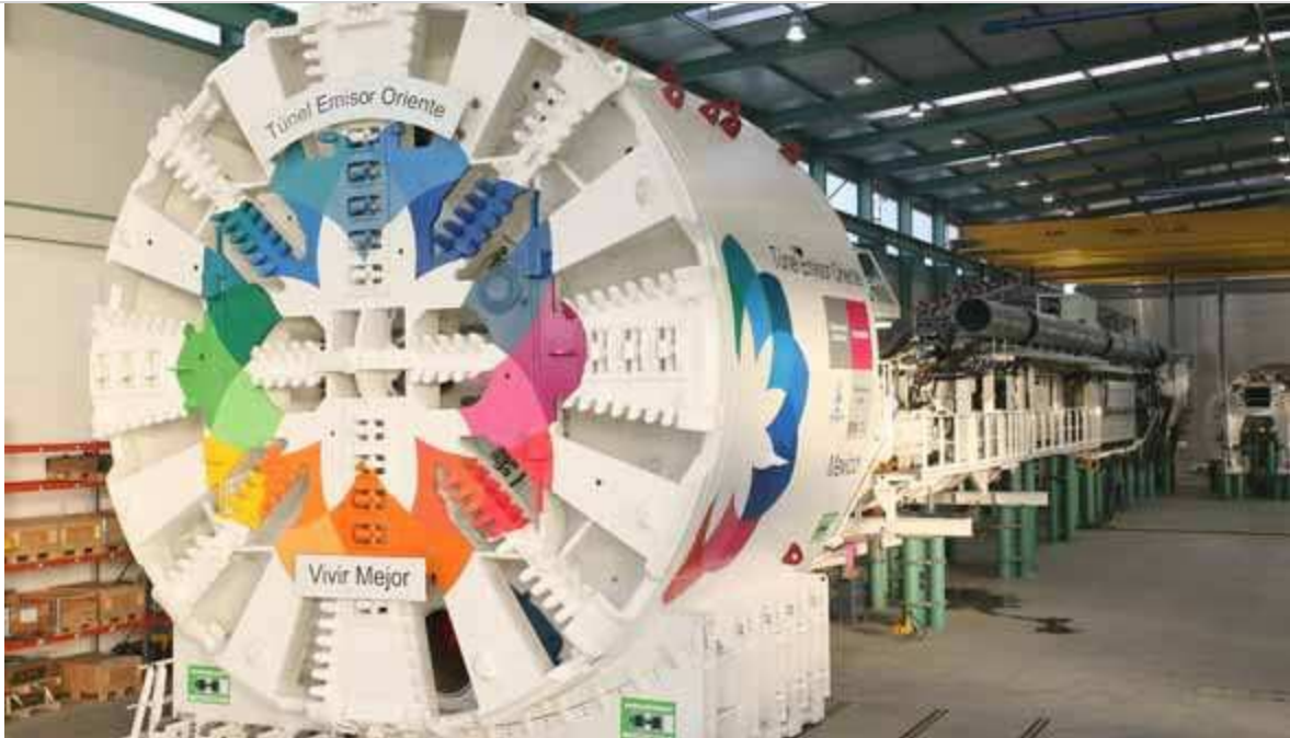
Figura 12.48. Escudo EPB del tramo 1, entre L-00 y L-05
