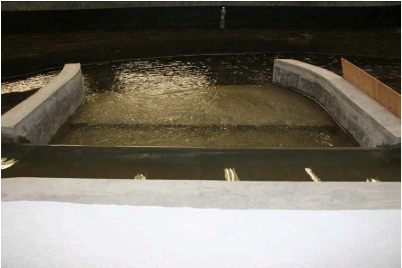
Figura 11.16. Modelo físico del vertedor de excedencias del TEO
